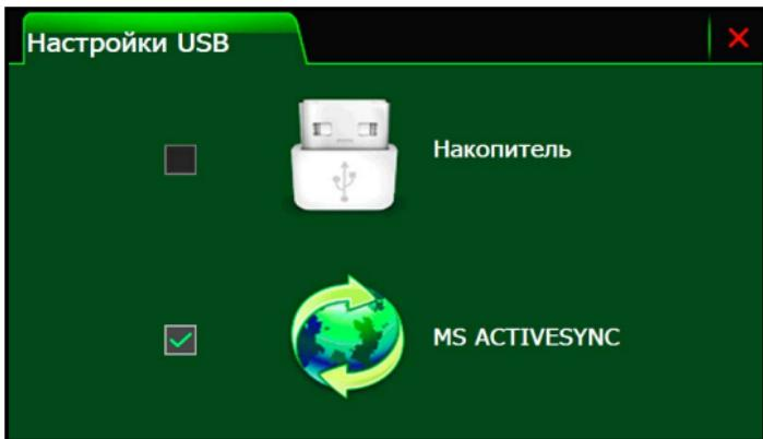
выберите соединение Навигатора с ПК с помощью программы ActiveSync или соединение с ПК в качестве внешнего накопителя.
