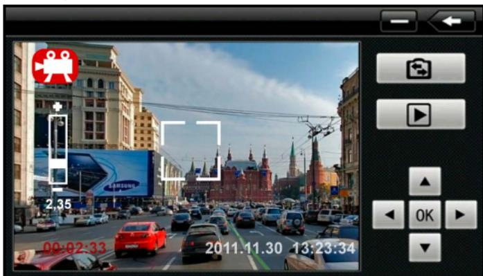
Индикатор, расположенный в левой верхней части экрана, показывает режим съемки (видеозапись или фото). В левой нижней части экрана отображается время, прошедшее с начала записи (для режима видеозапись), в правой нижней части экрана – дата и время съемки.
