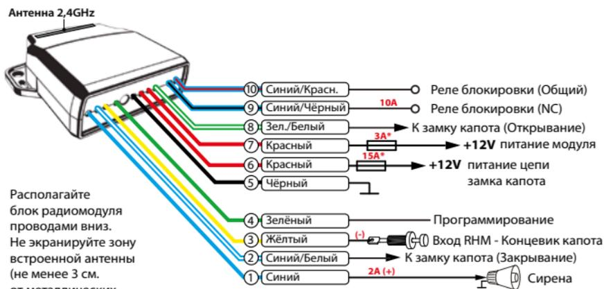
\* - Включение в цепь питания предохранителя - обязательное требование
