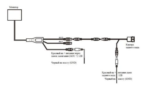
Желтый разъем монитора для подключения камеры заднего вида.
