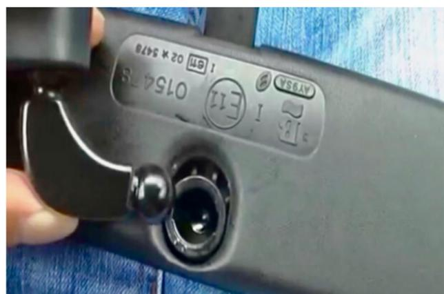
3. Определяем диаметр шарика штатного крепления и подбираем подходящий адаптер из комплекта SK-UNI.
