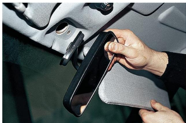
2. Откручиваем родное крепление из шарнира штатного зеркала Вашего автомобиля.
