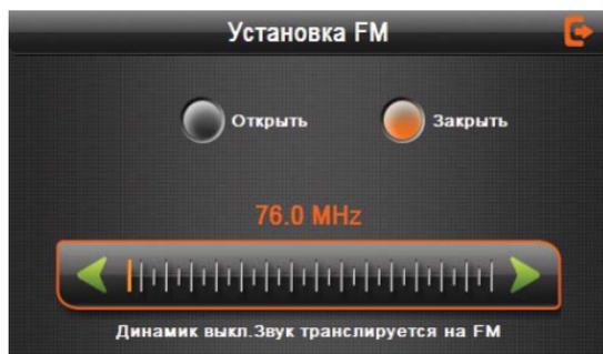
Выберите значение частоты, на которой будет осуществляться передача звука. Настройте на эту частоту радио Вашей автомагнитолы и нажмите «ВКЛ FM».
