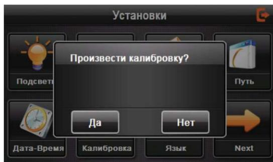
Калибровка экрана проводится для правильного позиционирования на экране. Прикоснитесь к центру курсора, во всех предложенных позициях – в центре, слева сверху, слева внизу, справа сверху и справа внизу экрана. Система автоматически завершит процедуру
