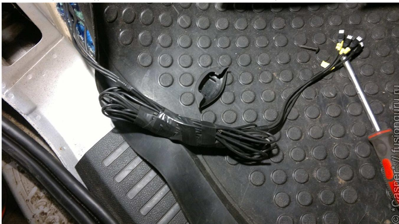
Чтобы этот пучок проводов, будучи замерзнувшем зимой не стал стучать по кузову или еще хуже скрипеть, обматываем его тряпичной изолентой.
